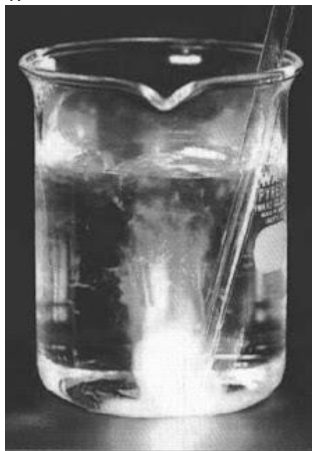
Gambar 1. Fosfor putih dalam air diaerasi dengan udara sehingga terjadi reaksi oksidasi disertai nyala api dalam air.
