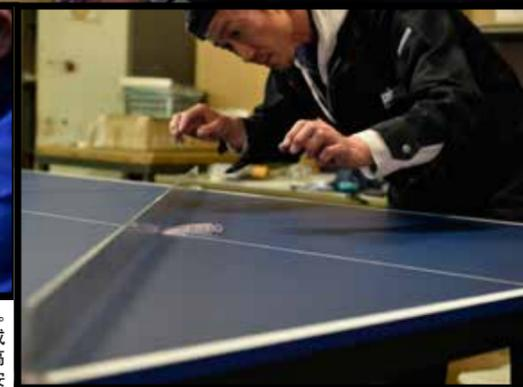
In der letzten Prüfung wird jedes Einzelteil der Platte nach den Kriterien des Regelwerks auf Höhe, Unebenheiten und viele weitere Punkte geprüft.
